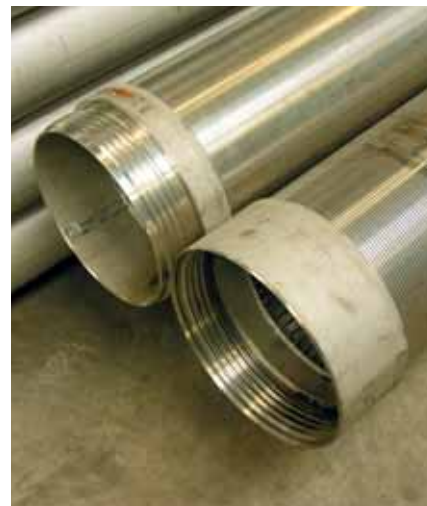
Filtr typu „Johnson” z połączeniem gwintowym okrągłym
