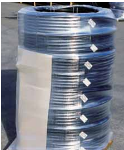
Sonda pionowa (podwójne "U") przygotowana do transportu na palecie drewnianej. Dla zapewnienia najwyższej jakości usług – sondy są zabezpieczone folią i tekturą falistą.
